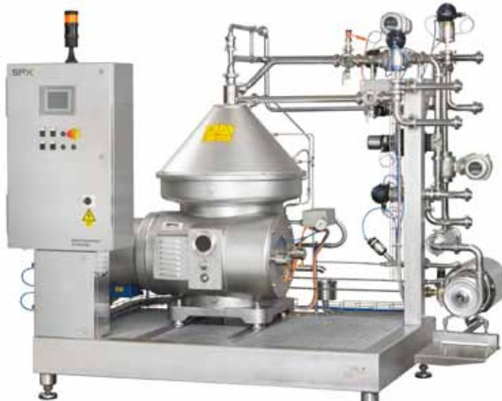
Industrie - Separator für die Polymer-Monomer-Trennung
